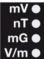
Die aufblitzende Einheit signalisiert den alternativen Messparameter, der durch kurzes Drücken der „Mode >“ Taste gewählt werden kann.
