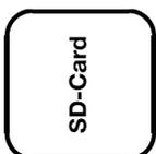
Hier befindet sich die Aufnahme für die SD Karte. Um einen versehentlichen Auswurf zu vermeiden, muss diese bis innerhalb der Gehäuseaußenkante eingeschoben werden, damit sie einrastet (ggf. Fingernagel oder Stift verwenden). Zum Entnehmen nochmals eindrücken, so dass sich die Einrastung wieder löst.
